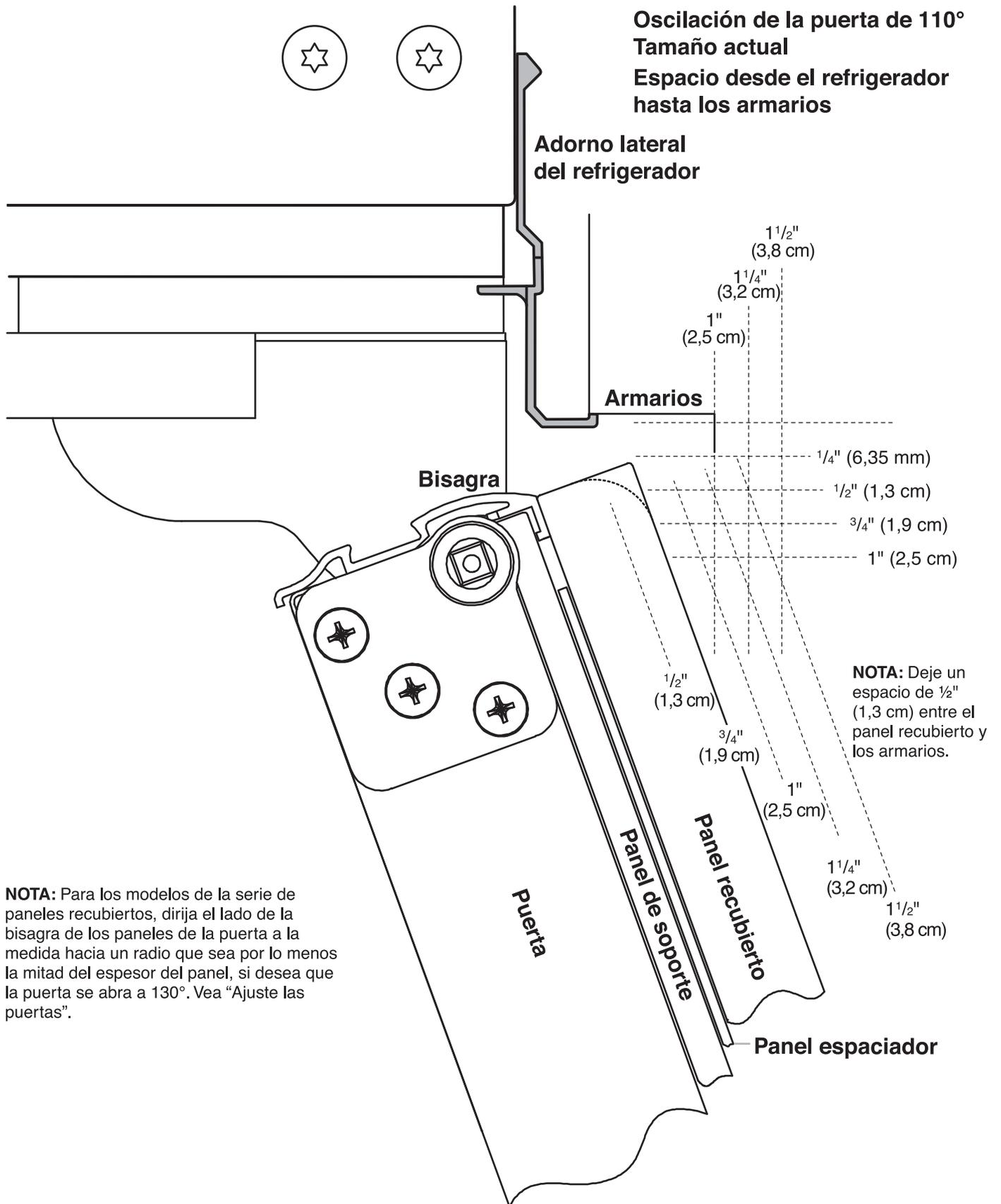
**NOTA:** Para los modelos de la serie de paneles recubiertos, dirija el lado de la bisagra de los paneles de la puerta a la medida hacia un radio que sea por lo menos la mitad del espesor del panel, si desea que la puerta se abra a 130°. Vea "Ajuste las puertas".
