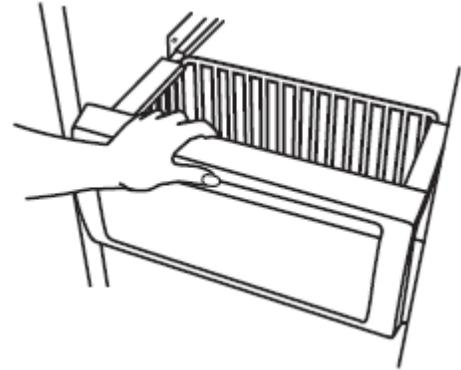
3. Vuelva a colocar la canastilla poniéndola en los rieles de guía de la pared lateral. Levante el frente de la canastilla ligeramente mientras la empuja pasando los topes de los rieles de guía y deslizándola hacia dentro por completo.
