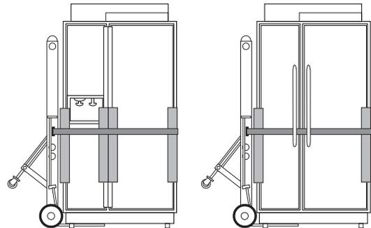
2. Coloque los trozos de la caja de envío en el suelo cuando haga rodar la carretilla y el refrigerador dentro de la casa. Acerque el refrigerador a la abertura incorporada.
