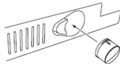
4. Gire la tapa hacia la izquierda hasta que la tapa se deslice en la ranura del accesorio. Luego, gire la tapa hacia la derecha hasta que quede en la posición horizontal.
