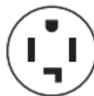
Tomacorriente de 4 hilos (14-30R)
