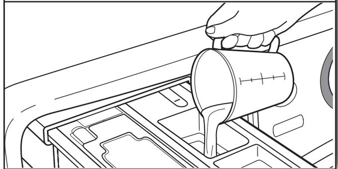
Ajouter une mesure d'agent de blanchiment liquide au chlore dans le compartiment d'agent de blanchiment. Ne pas remplir excessivement le distributeur, diluer le produit ou utiliser plus de  $\frac{2}{3}$  de tasse (165 ml). Ne pas ajouter d'agent de blanchiment sans danger pour les couleurs ou de produit Oxi dans le même programme avec l'agent de blanchiment liquide au chlore.
