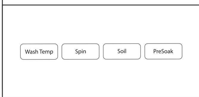
L'affichage indique les réglages par défaut correspondant au programme sélectionné. Pour ajuster un réglage, appuyer son nom – Wash Temp, Spin, Soil, ou PreSoak. Le fait d'ajuster les réglages modifiera la durée estimée restante. La laveuse peut également prolonger le programme si les vêtements sont tassés à l'intérieur, si la charge est déséquilibrée ou si la laveuse produit trop de mousse.
