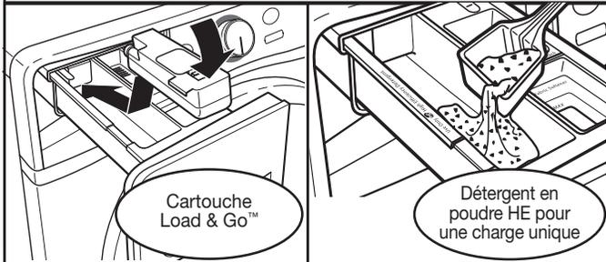
Ajuster le distributeur de détergent en fonction du type de détergent HE utilisé (liquide ou en poudre). Voir les instructions de la section "Utilisation du tiroir Load & Go™" pour savoir comment utiliser le distributeur.
