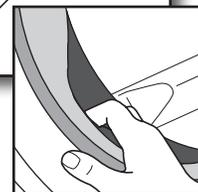
Retirer rapidement les vêtements une fois le programme terminé pour éviter que des odeurs ne se développent et que les objets métalliques faisant partie des vêtements ne rouillent. Lorsqu'on décharge les vêtements, irer le dispositif de verrouillage de la porte et vérifier qu'il ne reste pas de petits articles entre la cuve et le tambour.
