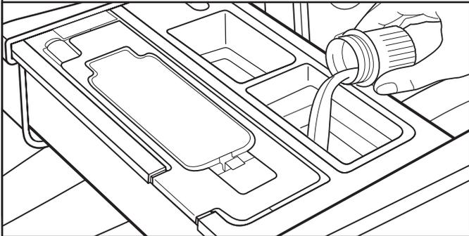
Verser une mesure de l'assouplissant pour tissu liquide dans le compartiment d'assouplissant pour tissu liquide. Toujours suivre les instructions du fabricant pour connaître la quantité d'assouplissant pour tissu adéquate en fonction de la taille de la charge.
