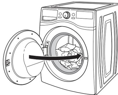
Placer une charge de linge trié dans la laveuse sans les tasser. Les articles doivent pouvoir se déplacer librement pour un nettoyage optimal et pour réduire le froissement et l'emmêlement. Fermer la porte de la laveuse en la poussant fermement jusqu'à ce que le loquet émette un clic.
